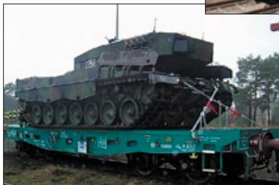
Zamocowanie czołgu LEOPARD na platformie kolejowej.
