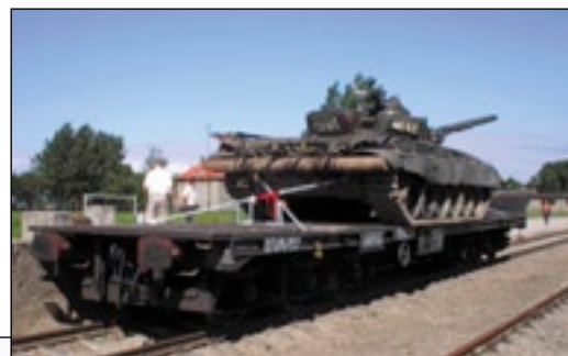
Zamocowanie czołgu T72 na platformie kolejowej.
